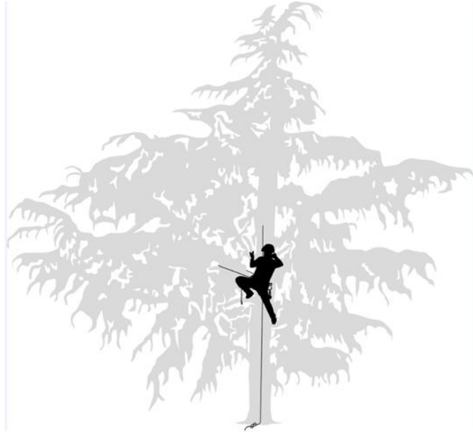
Fig. 10 caso di alternazione cordino con una fune
