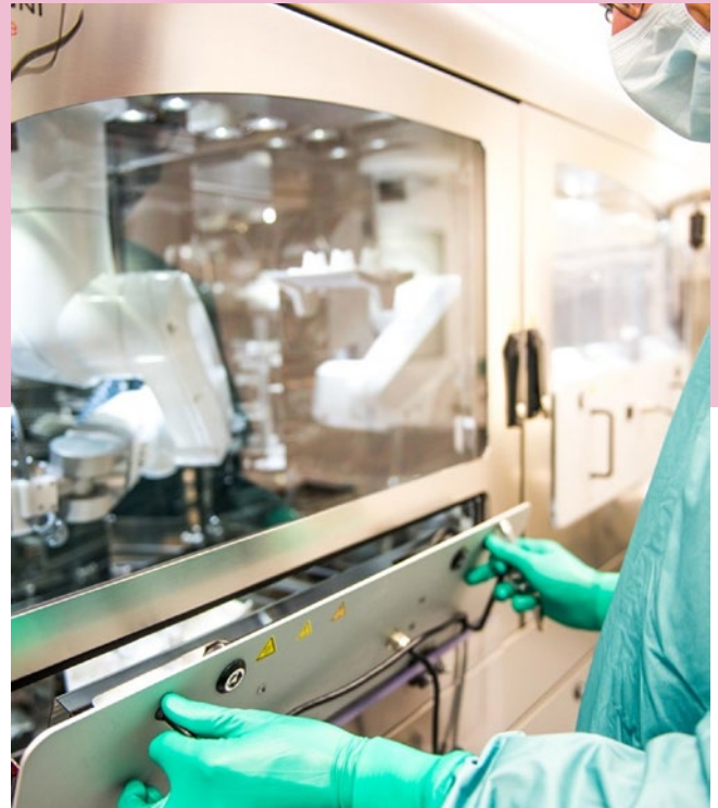
Figura 10-3: Preparazione di sacche per infusione con medicinali pericolosi in un sistema robotico automatizzato presso l'UMC di Amsterdam, Paesi Bassi. Gli operatori indossano dispositivi di protezione individuale
