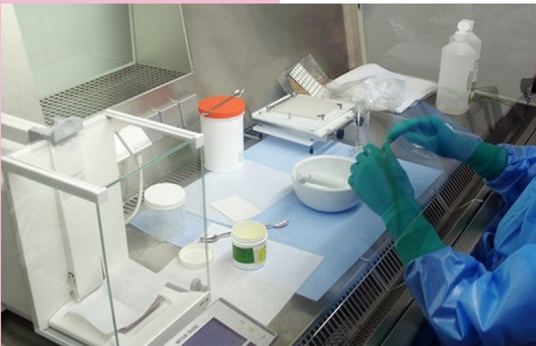
Figura 10-6: Produzione di capsule in un cappa di sicurezza biologica presso Pharma Assist BV, Paesi Bassi. L'utilizzo di medicinali pericolosi in polvere è un'attività ad alto rischio che può produrre particelle aerodisperse
